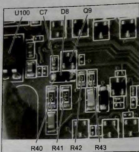
Рис. 8. Участок ЭМ с компонентами цепи тахогенератора
